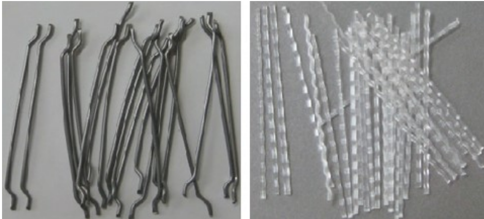
Kuva 2. Ruiskubetonissa käytettäviä Teräskuituja (vas.) ja polymeerikuituja (oik.). (Rakentaja.fi)
