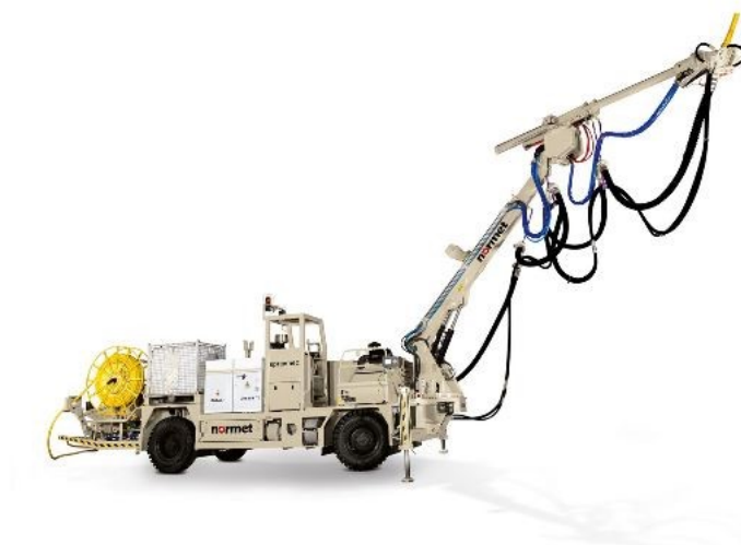
Kuva 3. Spraymec 8100 VC, ruiskubetonointilaitte (Normet 2020)
