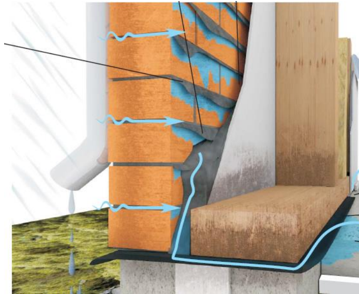
Kuva 10. Esimerkki puutteellisesta tiilimuurauksen taustatuuletuksesta. (Kosteus- ja hometalkoot 2012)
