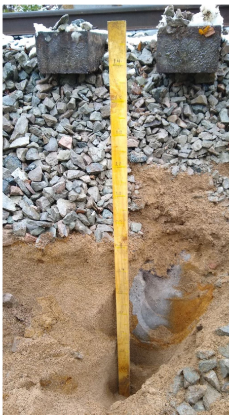
Kuva 6.5. Kontiomäellä koekuopasta 5 löytyi muuta rakennetta selvästi hienompaa hiekkaa.
