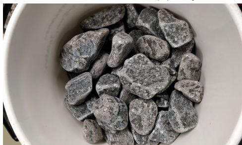
(b) Seulottu testinäyte micro-Deval -arvon määrittelyksen jälkeen.
