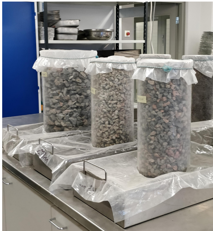
Kuva 3.4. Vedenimeytymiskorkeutta tutkitaan upottamalla testinäytteellä täytetyn putken alapää vesiastiaan. (Kuva: Anne Sailaranta 2020)
