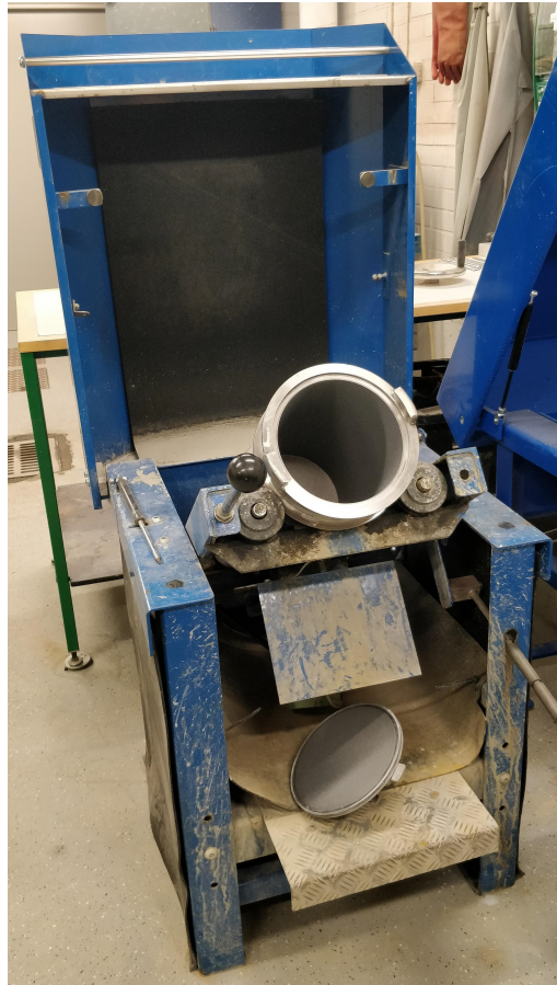
Kuva 4.3. Tampereen yliopiston geolaboratorion testilaitte micro-Deval -arvon määrittä- miseen. (Kuva: Anne Sailaranta 2020)
