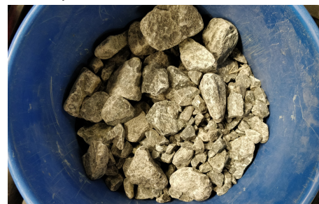
(c) Seulottu testinäyte LA-luvun määrittelyksen jälkeen.
