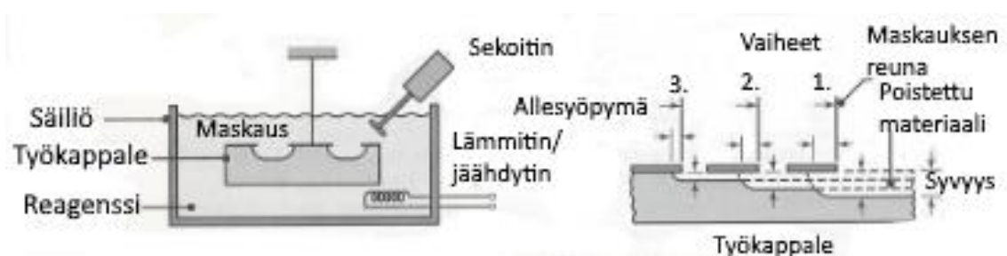
Kuva 15. Kemiallisen työstämisen laitteisto (Kalpakjian ja Schmid, 2006, s. 838).
