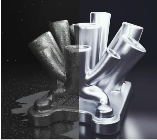
Kuva 19. 3D-tulosteen tukirakenteiden poistaminen kemiallisesti (Hirtenberger, 2017).
