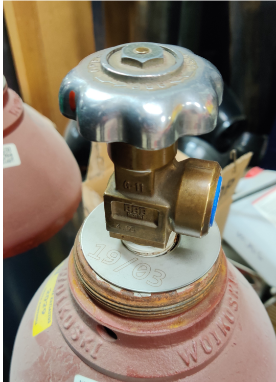
Kuva 2.1. Kaasupullon venttiilin alle on asetettu merkintärenkas. Renkaaseen on merkitty edellisen katsastuksen ajankohta. Rengasta ei saa poistettua ehjänä irrottamalla venttiiliä. Kuvan mukainen merkintä on standardin SFS–EN ISO 13769 2018 mukaan pysyvä merkintä.
