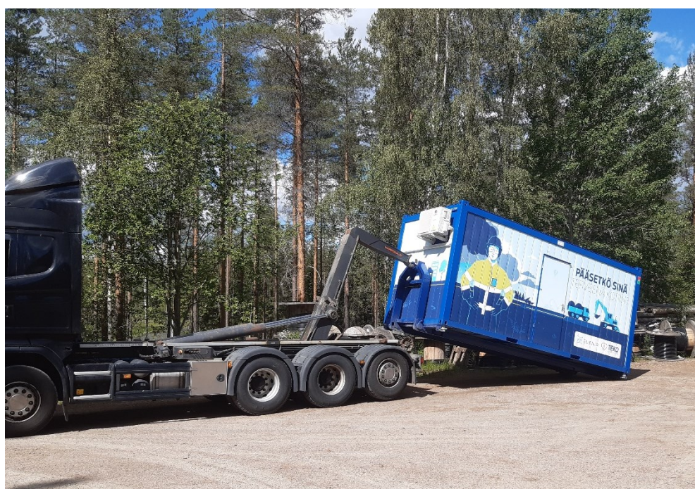
Kuva 10. Kontin lastaaminen kuljetusta varten hyödyntäen koukkulavalaitetta
