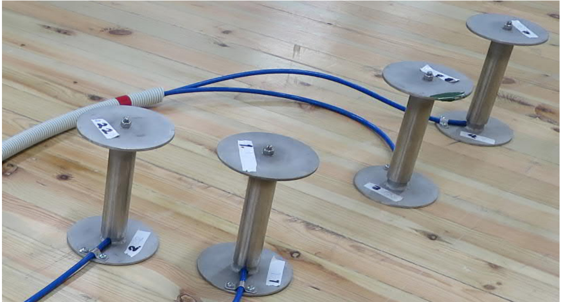
Kuva 32 Kantavan kerroksen kokoonpuristuma-antureita.
