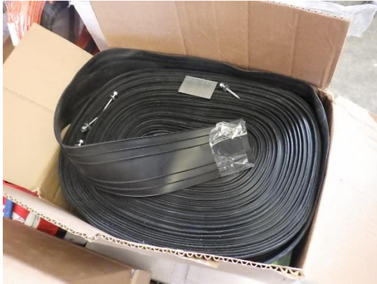
Kuvat 5. Julkisivun levyjen saumat toteutetaan kumikaistalla, jonka päälle tulee elastinen saumamassa.
