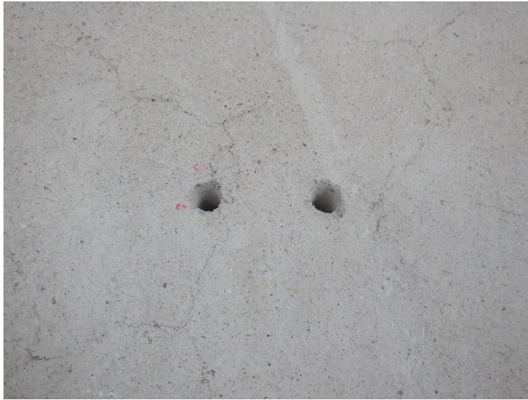
Kuva 2. Kosteusmittaukset on toteutettu porareikämenetelmällä.
