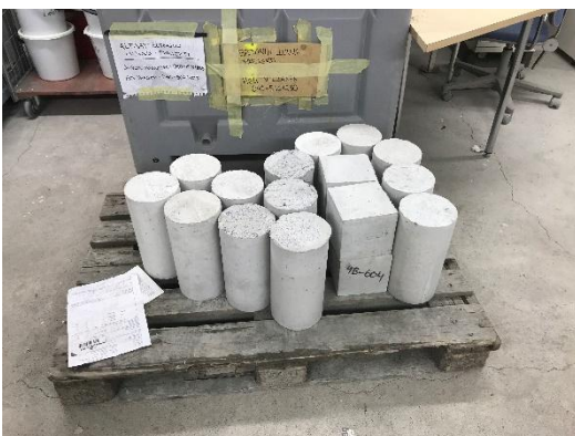
Kuva 23. Valettuja standardikuutiota ja -lieriöitä, sekä timanttiporattavia valulieriöitä.
