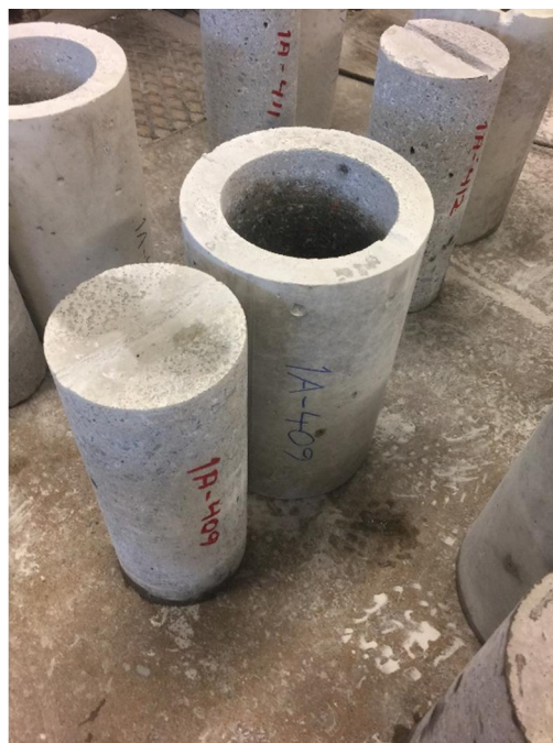
Kuva 8. Halkaisijaltaan 150 mm rakennekoekappale ja timanttiorattu valukappale D235x340.
