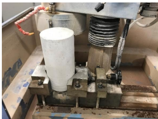
Kuva 3. Koneellinen hionta, standardilieriön hionta.
