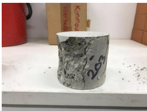
Kuva 5. Tyypillinen valetun D100x100 koekappaleen murtuminen puristuskokeessa.
