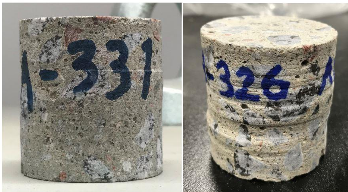
Kuva 73. Timanttioranterän kunnan vaikutus porauspinnan laatuun. Vasemmalla hyväkuntoisella ja oikealla tyypillinen huonokuntoisella timanttiterällä porattu rakennekoekappale.
