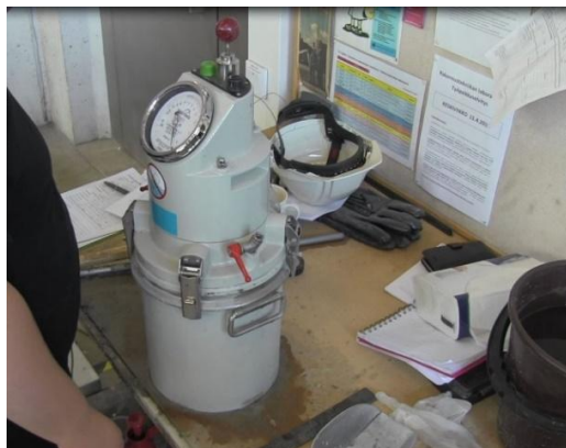
Kuva 13. Betonimassan ilmamäärän mittaaminen, paineen tasaus.
