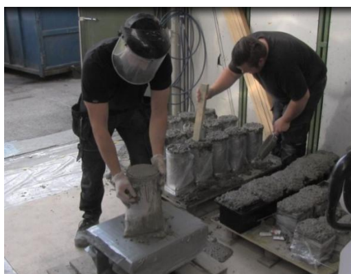
Kuva 5. Standardilieriön tiivistäminen tärypöydällä.
