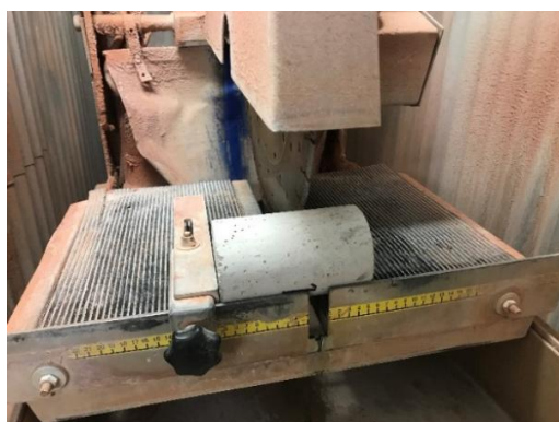
Kuva 3. Koekappaleet tuettiin timanttisahauksessa sekä pituus- että poikkisuunnassa.
