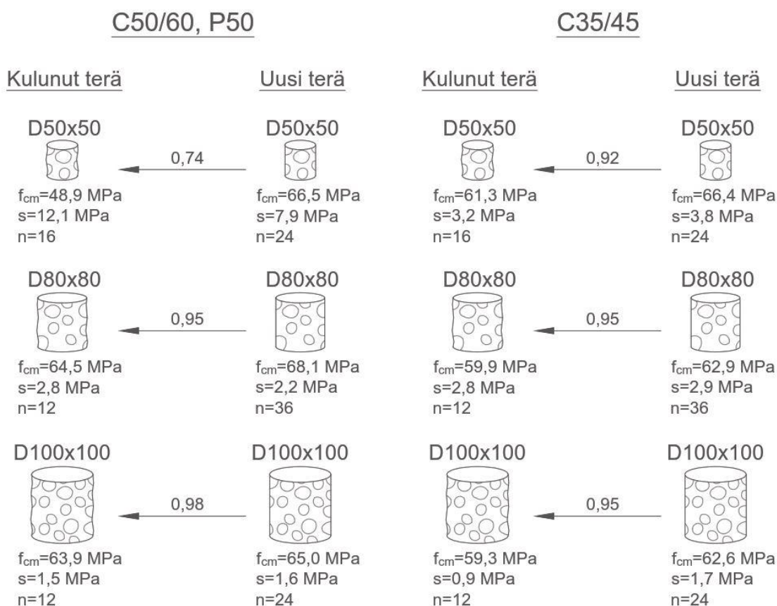
Kuva 58. Betonilaatujen C50/60 P50 ja C35/45 kuluneella ja uudella timanttiterällä porattujen rakennekoekappaleiden puristuslujuuksien väliset suhteet, mittaustulosten keskiarvot ja koekappalemäärät.
