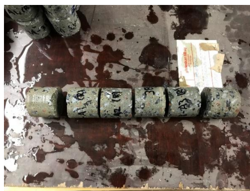
Kuva 4. Nimellishalkaisijaltaan 50 mm rakennekoekappaleiden katkaisu. Pituudeltaan 150 mm poralieriöstä katkaistiin neljä D50x50 rakennekoekappaletta siten, että ylä- ja alapäästä poistettiin saman verran betonia.
