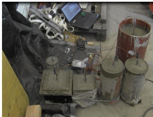
Kuva 14. Hydrataatiolämpötilan mittaaminen. Valukappaleiden massakeskipisteeseen on asennettu mittauslangat.
