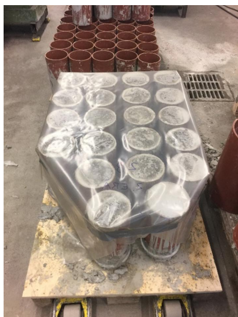
Kuva 15. Valukappaleiden jälkihoito muotteissa suoritettiin tiiviisti kiinnitetyllä muovikalvolla.
