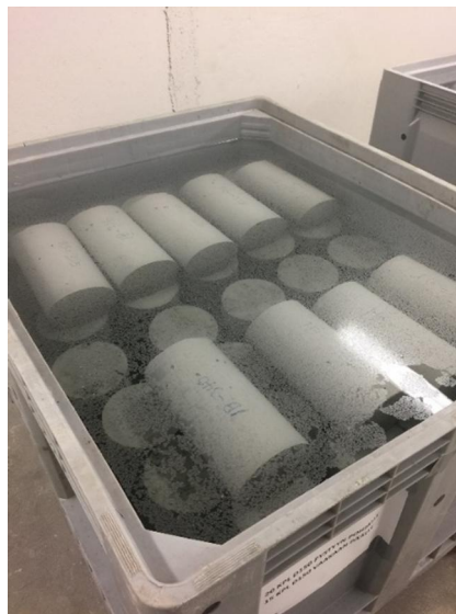
Kuva 20. Lujuudenseurantakoekappaleita säilytettiin vesiupotuksessa puristuskokeiden suorittamiseen saakka.
