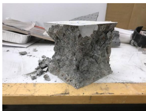
Kuva 4. Tyypillinen standardikuution murtuminen puristuskokeessa.
