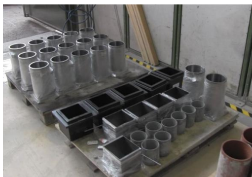
Kuva 1. Standardikoekappaleiden ja valettujen koekappaleiden muotit juuri ennen valua.
