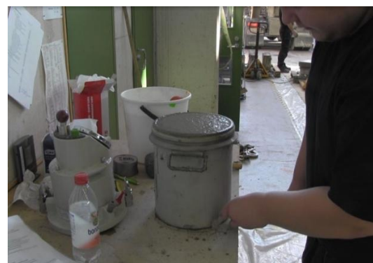
Kuva 12. Betonimassan ilmamäärän mittaminen, tiivistetty betonimassa on juuri tassattu mitta-astian yläpinnan tasoon.
