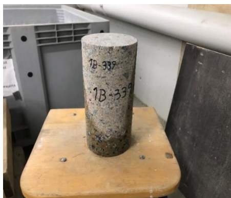
Kuva 4. Hiomalla tasoitettu D100x200 rakennekoekappale.
