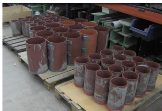
Kuva 2. Rakennekoekappaleiden timanttiorausta varten valettavien kappaleiden valumuotit.
