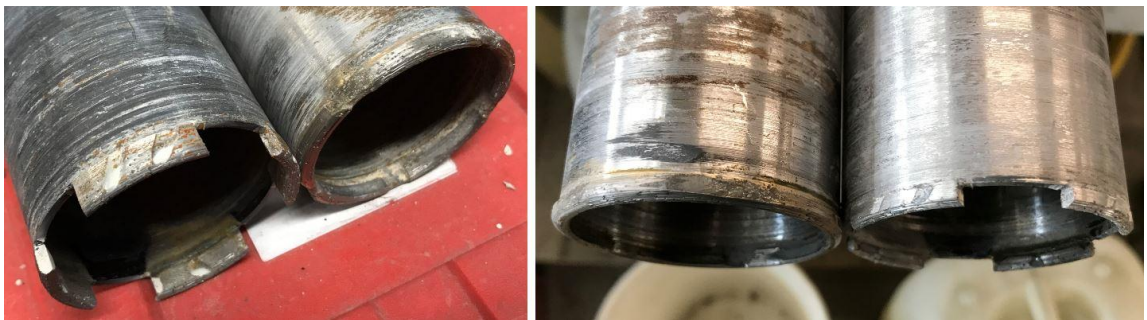
Kuva 25. Nimellishalkaisijaltaan 50 mm timanttikorakruunut ennen tutkimuksen aloittamista (vasemmalla) ja tutkimuksen päätteeksi (oikealla).
