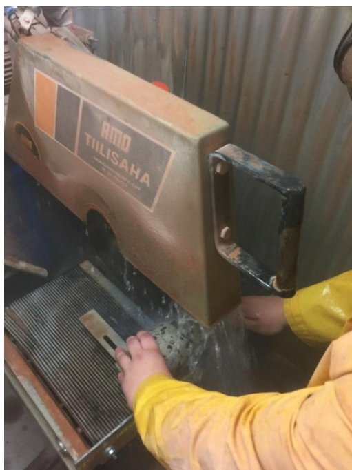
Kuva 1. Koekappaleet katkaistiin suunniteltuun pituuteen timanttisahaamalla, jossa sahattavaa kappaleetta huuhdeltiin kylmällä vedellä katkaisun ajan.
