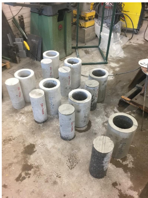
Kuva 7. Nimellishalkaisijaltaan 150 mm rakennekoekappaleet ja timanttioratut valukappaleet D235x340.
