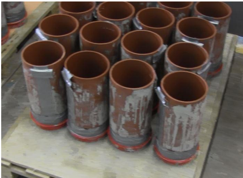
Kuva 16. Timanttiorattavien rakennekoekappaleiden valukappaleiden D150x300 muovinen lieriömuotti.
