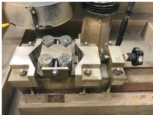
Kuva 1. Koneellinen hionta, nimellishalkaisijaltaan 50 mm rakennekoekappaleet kiinnitettiin hionta-adaptteriin, kerralla saatiin hiottua neljä rakennekoekappaleetta
