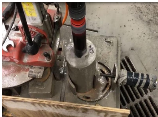
Kuva 1. Halkaisijaltaan 50 mm poralierion timanttiporaus. Valulieriö on tiukasti kiinnitettynä porausjalustaan.
