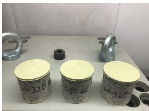
Kuva 9. Nimellishalkaisijaltaan 80 mm rikkiseoksella tasoitetut rakennekoekappaleet.
