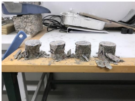
Kuva 7. Tyypillinen rakennekoekappaleen D50x50 murtuminen puristuskokeessa.
