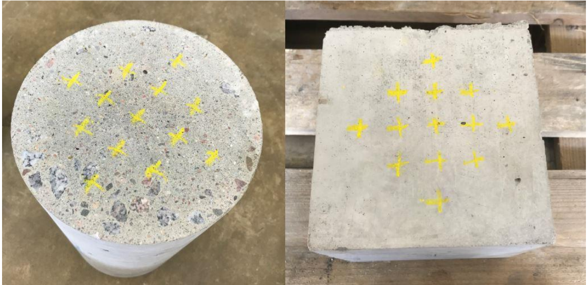
Kuva 32. Merkatut iskukohtat lieriömäisen (vasemmalla) ja kuutiomaisen (oikealla) koekappaleen pinnalla.
