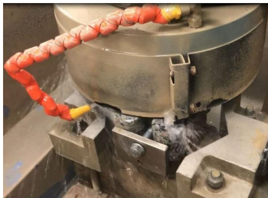
Kuva 2. Koneellisessa hionnassa koekappaleiden hiottavia päitä huuhdeltiin koko hionnan ajan kylmällä vedellä.
