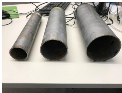
Kuva 6. Nimellishalkaisijaltaan 50, 80 ja 100 kuluneet timanttiterät tutkimuksen päätteeksi.
