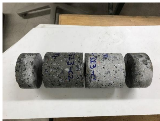
Kuva 6. Nimellishalkaisijaltaan 100 mm rakennekoekappaleiden katkaisu. Pituudeltaan 150 mm poralieriöstä katkaistiin kaksi D100x100 rakennekoekappaletta siten, että ylä- ja alapäästä poistettiin saman verran betonia.
