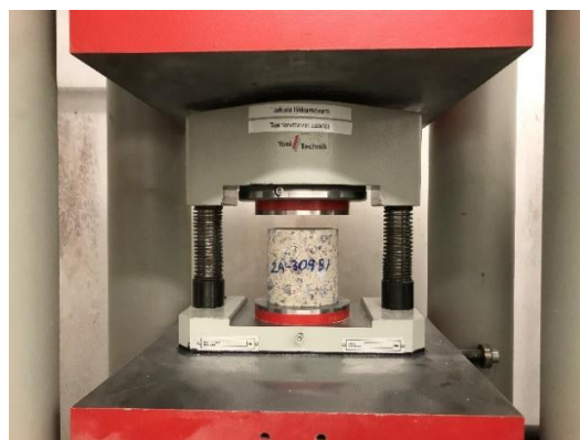
Kuva 2. Halkaisijaltaan 50-100 mm koekappaleiden puristuskokeissa käytettiin puristusadapteria.
