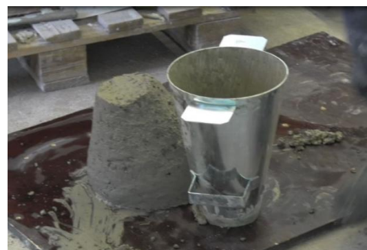
Kuva 10. Painumakoe, katkaistukartio on juuri poistettu.
