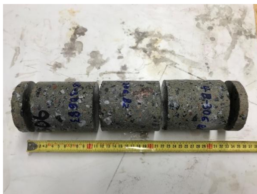
Kuva 5. Nimellishalkaisijaltaan 80 mm rakennekoekappaleiden katkaisu. Pituudeltaan 150 mm poralieriöstä katkaistiin kolme D80x80 rakennekoekappaletta siten, että ylä- ja alapäästä poistettiin saman verran betonia.
