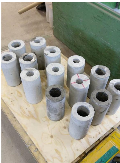
Kuva 9. Timanttioratut valukappaleet D150x300. Valukappaleista on porattu nimellishalkaisijoiltaan 50 mm ja 80 mm poralieriöitä.
