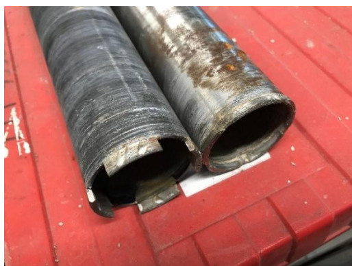
Kuva 3. Nimellishalkaisijaltaan 50 mm timanttiterät tutkimukset päätteeksi, vasemmalla uusi ja oikealla kulunut.
