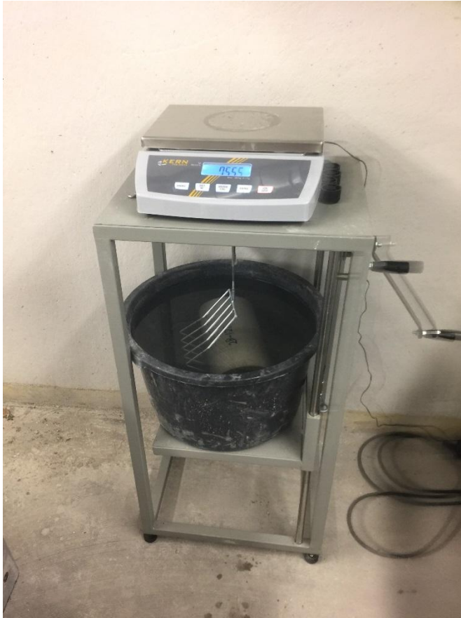
Kuva 28. Koekappaleiden tilavuuden määrittämisessä käytetty nostokorikehikko ja vaaka. Vaa'an alapuolisesta mittauskoukusta roikotetaan koria, jossa koekappaletta pidetään.
