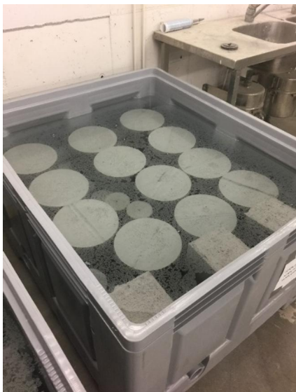
Kuva 19. Kaikkia koekappaleita ja timanttiporattavia valukappaleita jälkihoidettiin vesiupotuksessa 28 vuorokauden ikään saakka.
