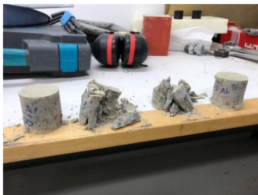
Kuva 9. Rikkiseoksella tasoitettujen D50x50 rakennekoekappaleiden hylättyjä koekappaleita (keskellä).
