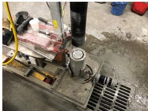
Kuva 2. Halkaisijaltaan 100 mm poralierion timanttiporaus. Valulieriö on tiukasti kiinnitettynä porausjalustaan.
