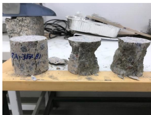
Kuva 6. Tyypillinen rakennekoekappaleen D80x80 murtuminen puristuskokeessa.
