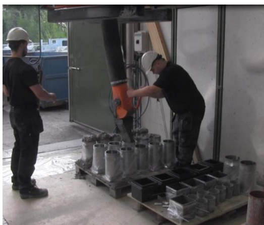
Kuva 4. Betoni laskettiin jassikan pohjassa olevasta annosteluletkusta suoraan muotteihin.
