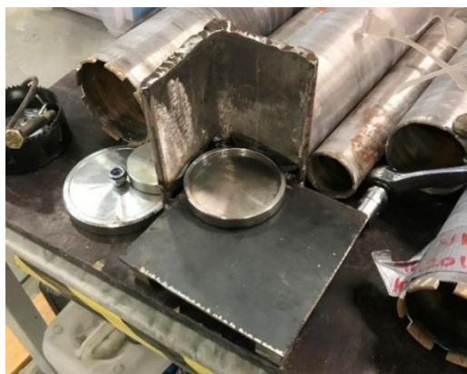
Kuva 5. Rikitysteline, telineessä kiinni rikityskuppi halkaisijaltaan 80 mm rakennekoekappaleille.
