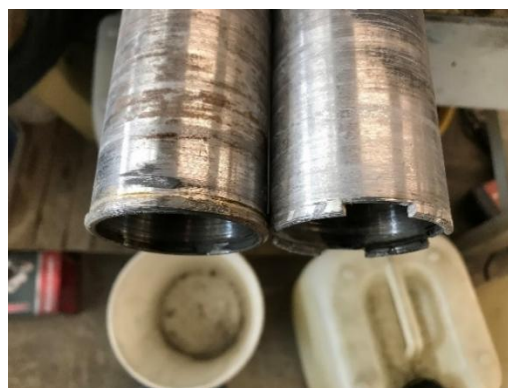
Kuva 4. Nimellishalkaisijaltaan 80 mm timanttiterät tutkimuksen päätteeksi, vasemmalla kulunut ja oikealla uusi.
