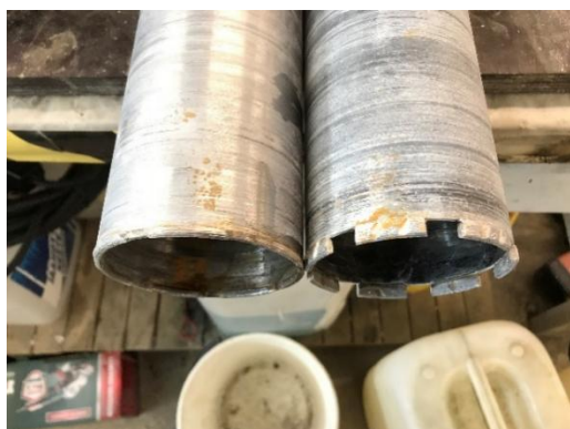
Kuva 5. Nimellishalkaisijaltaan 100 mm timanttiterät tutkimuksen päätteeksi, vasemmalla kulunut ja oikealla uusi.
