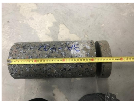
Kuva 7. Nimellishalkaisijaltaan 150 mm rakennekoekappaleiden katkaisu. Pituudeltaan 150 mm poralieriöstä katkaistiin yksi D150x300 rakennekoekappaletta siten, että yläpäästä (valupinnasta) poistettiin betonia.
