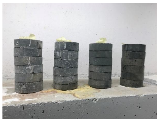
Kuva 8. Tiheystutkimuksessa standardilieriöitä D150x300 sahattiin 50 mm korkeiksi kiekkoiksi.
