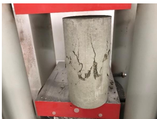
Kuva 3. Tyypillinen standardilieriön murtuminen puristuskokeessa.
