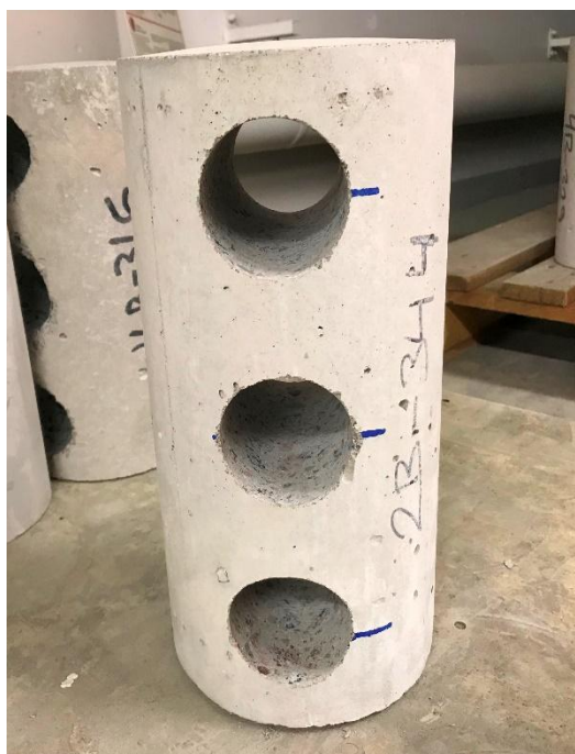
Kuva 10. Tiheystutkimuksessa valukappaleista timanttiorattiin koekappaleita vaakasuunnassa.
