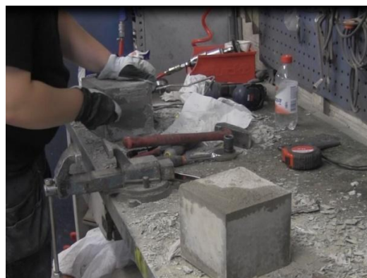
Kuva 18. Muottien purkaminen suoritettiin työtasoilla, muotit purettiin valujärjestyksessä.
