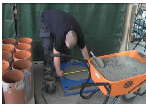
Kuva 9. Leviämäkokeen tuloksen mittaminen.
