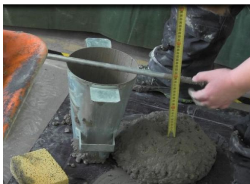
Kuva 11. Painumakokeen tuloksen mittaminen.
