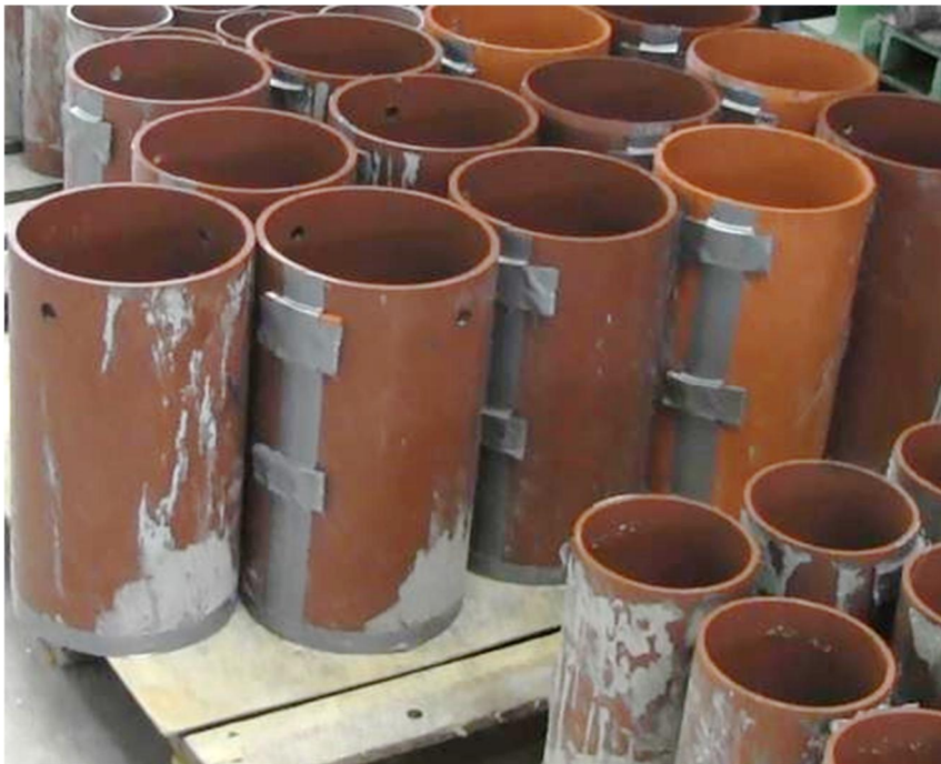
Kuva 17. Timanttiporattavien rakennekoekappaleiden valukappaleiden D235x340 muovinen lieriömuotti. Muotit on valmistettu ylikorkeina, jotta muottien yläreunaan on pysytty poraamaan nostoreiät muottien siirtämisen helpottamiseksi.
