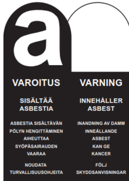
Kuva 2. Asbestia sisältävän esineen tai pakkauksen varoitusmerkintä (Ratu 82-0347 2009)
