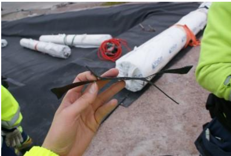
DSC04585 Näytesauma kokeen jälkeen
