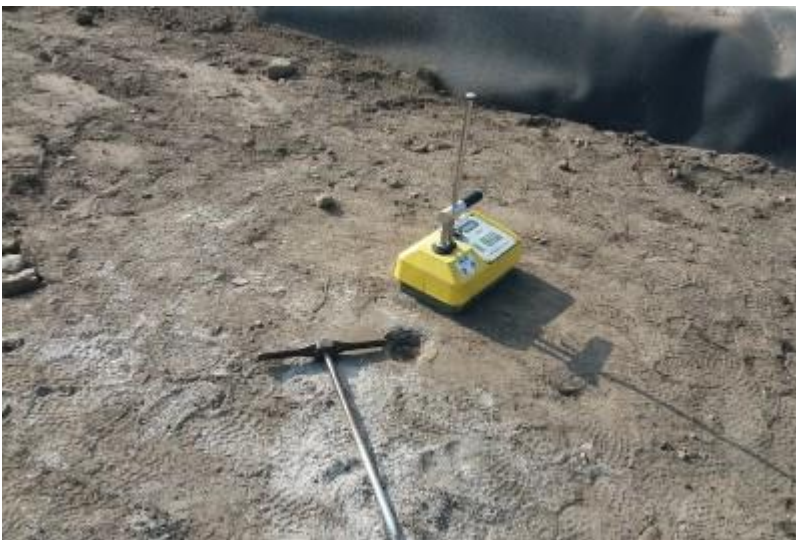
20180824_114209 Troxler-mittaus vesivolymetrin vierestä (Leppänen 2018)
