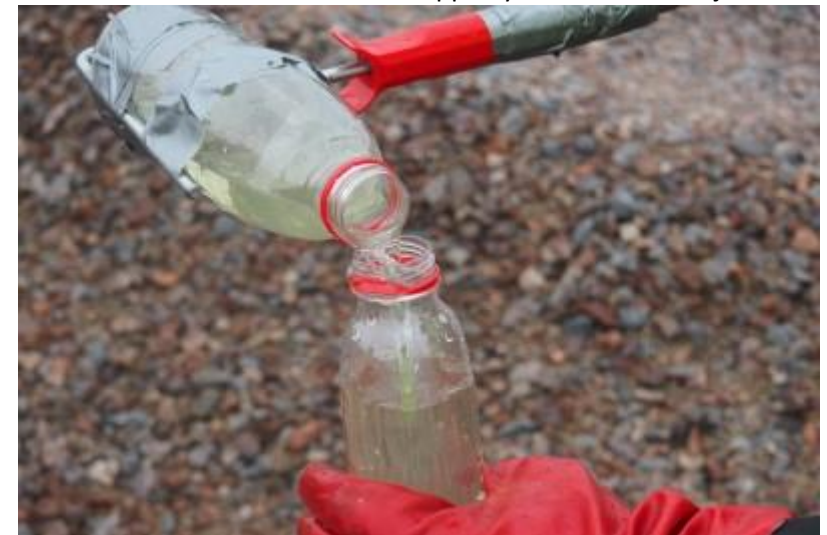
P4091296 Näytteen kaataminen näytteenottimesta
