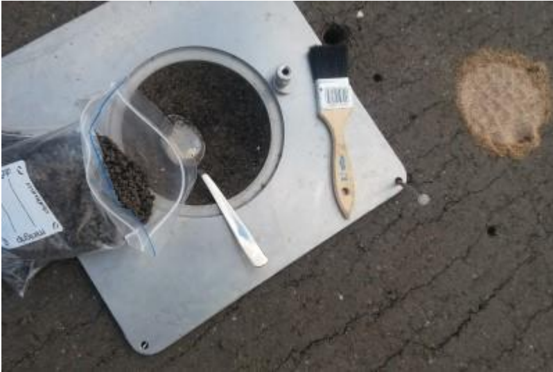
17.27.14 Vesivolymetri troxlerin ja hiekkavolymetrin vierestä (Leppänen 2018)
