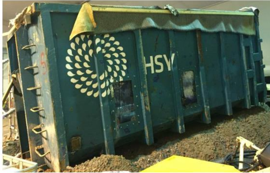
Kuva 15. HSY:n kokeissa käytetty lavalysimetri, joka on rakennettu vanhasta jätelavasta. Lavan kyljessä on ikkunat, joista voi voidaan havainnoida kapillaari-ilmiötä. (Kurikkala 2018)
