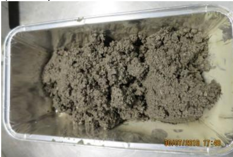
Kuonafraktio 0/5 mm, Kappale ei pysynyt koossa purkamisen jälkeen
