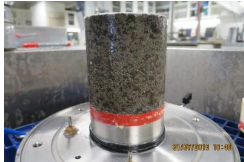
Koekappale V4a kokeen jälkeen
