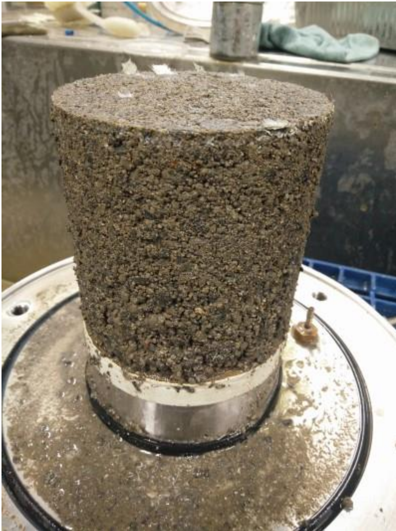
Bitumikuona, koekappale V4 kokeen jälkeen
