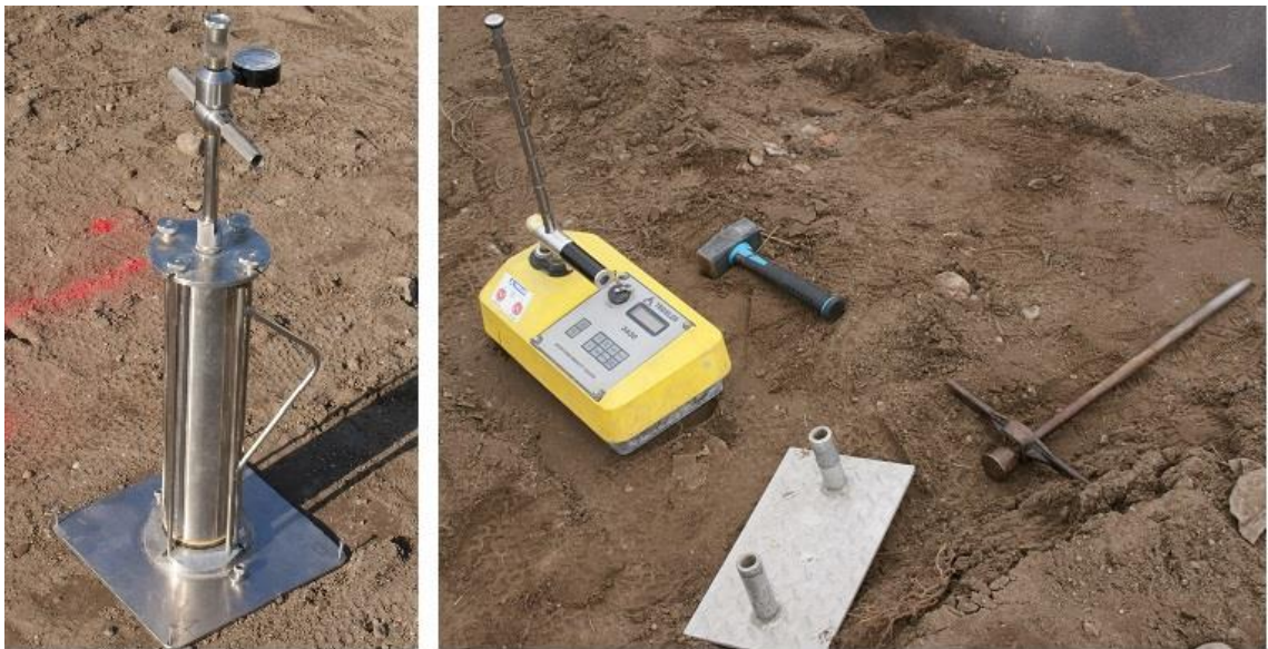
Kuva 30. Vasemmalla vesivolymetri ja oikealla troxler-mittalaite (malli 3430) sekä mittaukseen tarvittavat apuvälineet (Reiman 2018).
