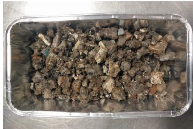
Kuonafraktio 12/35 mm kokeen jälkeen. Kappale ei pysynyt koossa purkamisen jälkeen
