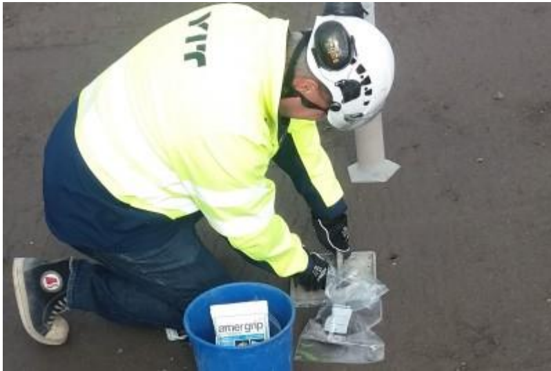
151802 Urakoitsija tekemässä hiekkavolyometriä (Leppänen 2018)
