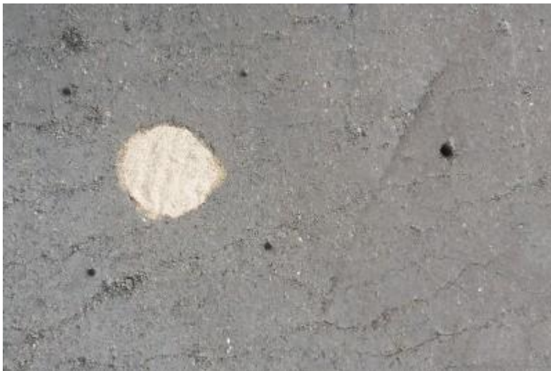
151847 Hiekkavolyometri tehty troxler-mittauksen vierestä (Leppänen 2018)
