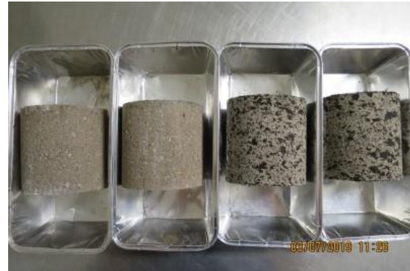
Joustavaseinämäisten vedenläpäisevyyksien toinen sarja kuivana kokeen jälkeen. Vasemmalta oikealle kuonabentoniitti V1a ja V2a & bitumikuona V3a ja V4a
