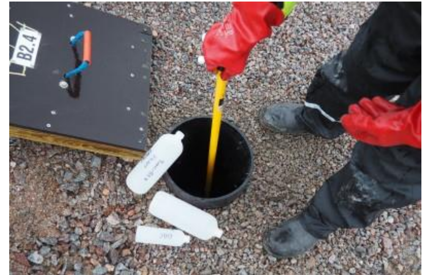
P4091266 Kaivon sekoittaminen happinäytteen ottamisen jälkeen
