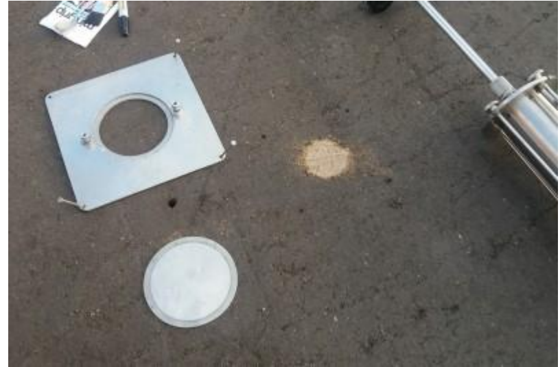
17.38.09 Toinen vesivolymetri troxlerin ja hiekkavolymetrin vierestä (Leppänen 2018)
