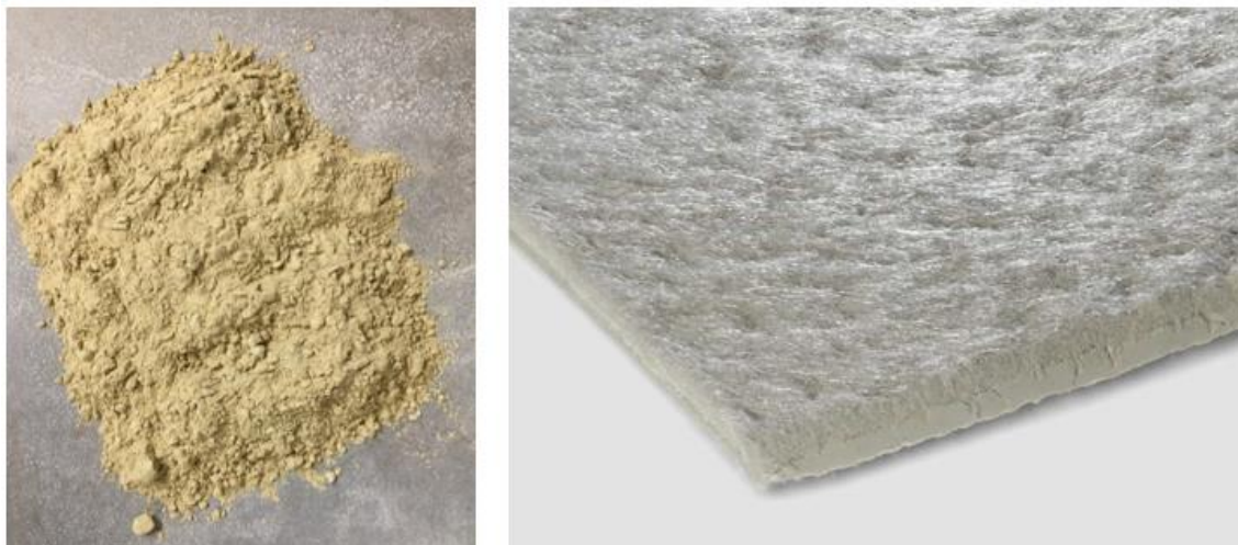
Kuva 7. Vasemmalla bentoniittijauhe ja oikealla bentoniittimatto (Kinnunen 2017; Naue 2019).
