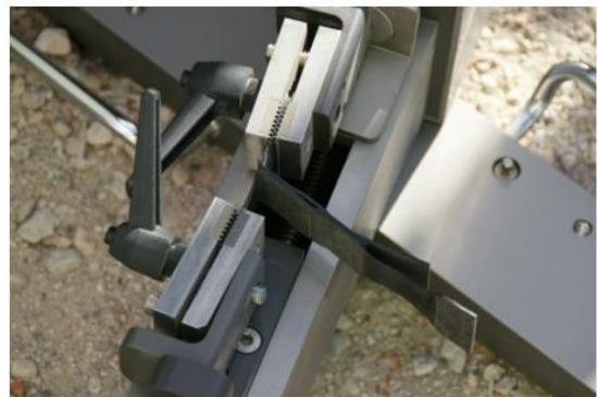
Kuva 34. Vasemmalla läpiviennin ekstruusiosausaus ja oikealla kuorintakoe kaksoissaumasta (Reiman 2018).
