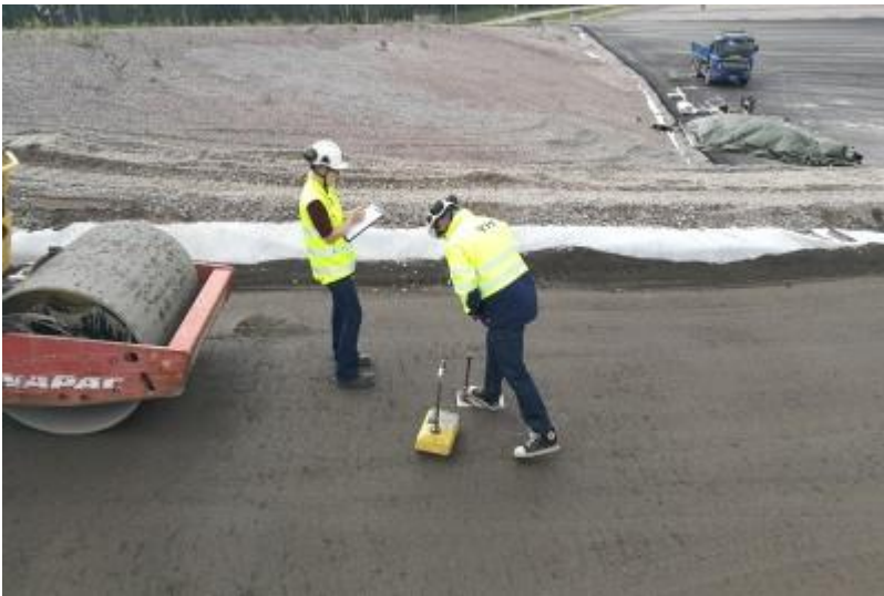
140713 Urakoitsijan troxler-mittaus (Vahanen 2018)
