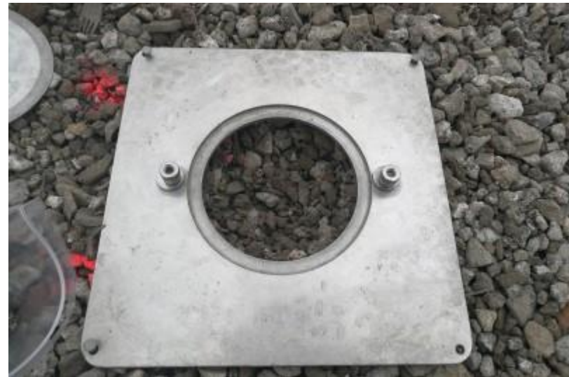
101622 Kuivatuskerroksen vesivolymetri (Vahanan 2018)
