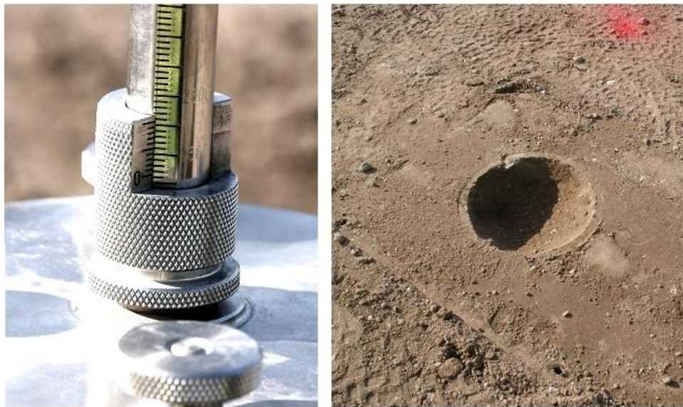
Kuva 31. Vasemmalla vesivolymetrin mitta-asteikko ja oikealla kuoppa mittauksen jälkeen (Reiman 2018).
