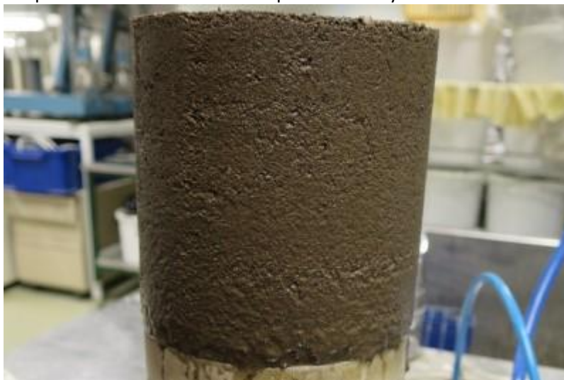
Koepintarakenteen A.1 pintakerroksen Hki-moreeni. Sivusta
