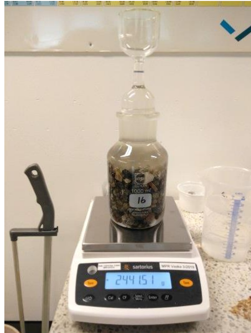
Kiintotiheys: kuonafraktio 12/35 mm, jae 4/16 pyknometrissä
