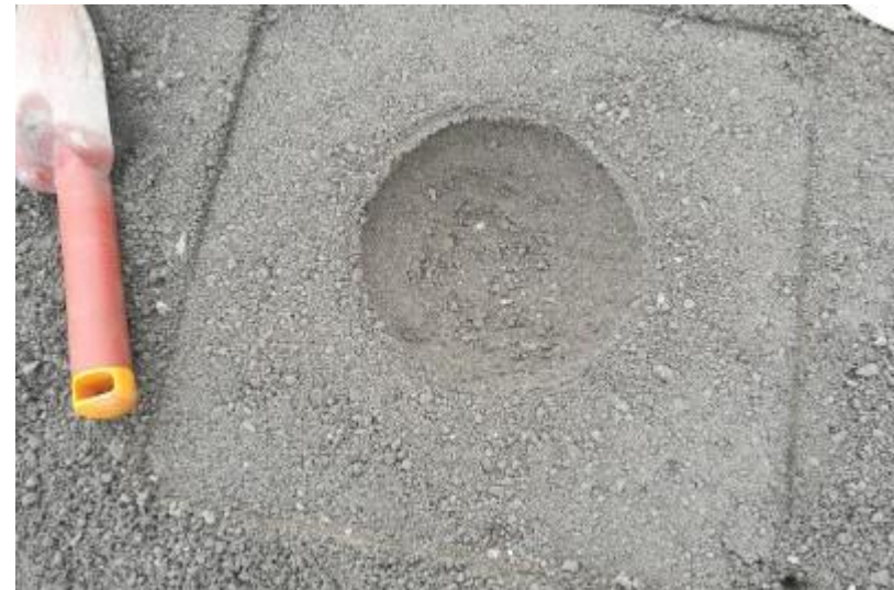
161932 Vesivolymetrin kuoppa kapillaarieristeessä (Vahnen 2018)
