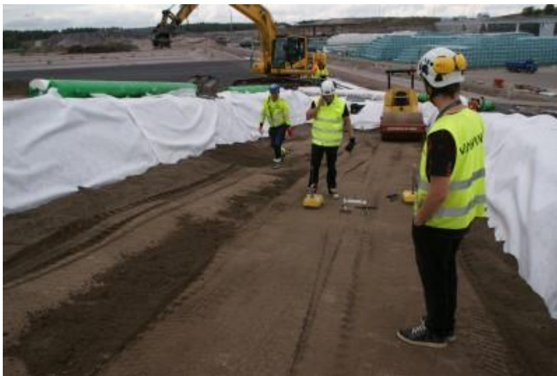
DSC05046 Urakoitsijan 1. jyräyksen troxler-mittaus
