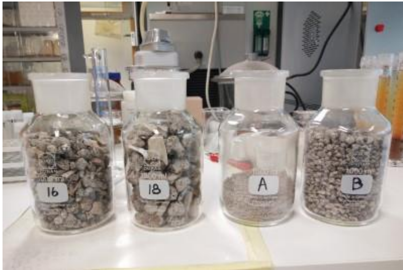
Kiintotiheys: kuonien testinäytteet. 16 kuona 12/35 mm 4/16 jae, 18 kuona 12/35 mm > 16 mm jae, A kuona 0/5 mm 0/4 jae & B kuona 5/12 mm 4/16 jae
