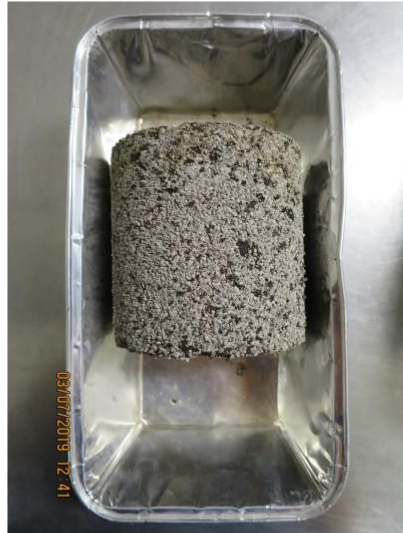
Koekappale V3 kuivana kokeen jälkeen
