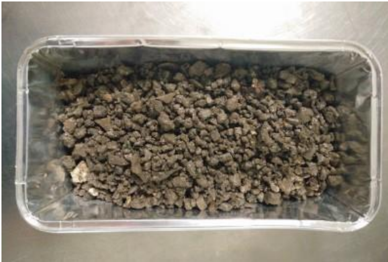
Kuonafraktio 5/12 mm kokeen jälkeen. Kappale ei pysynyt koossa purkamisen jälkeen
