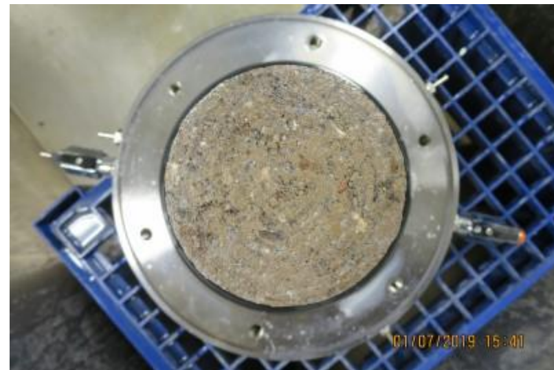
Koekappaleen V2a pääty kokeen jälkeen
