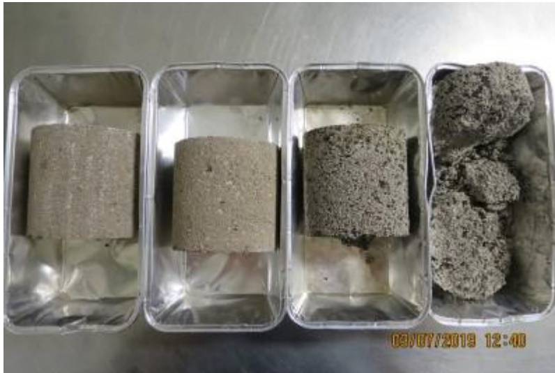
Joustavaseinämäisten vedenläpäisevyyksien ensimmäinen sarja kuivana kokeen jälkeen. Vasemmalta oikealle kuonabentoniitti V1 ja V2 & bitumikuona V3 ja V4. V4 hajosi näytteen purkamisen yhteydessä
