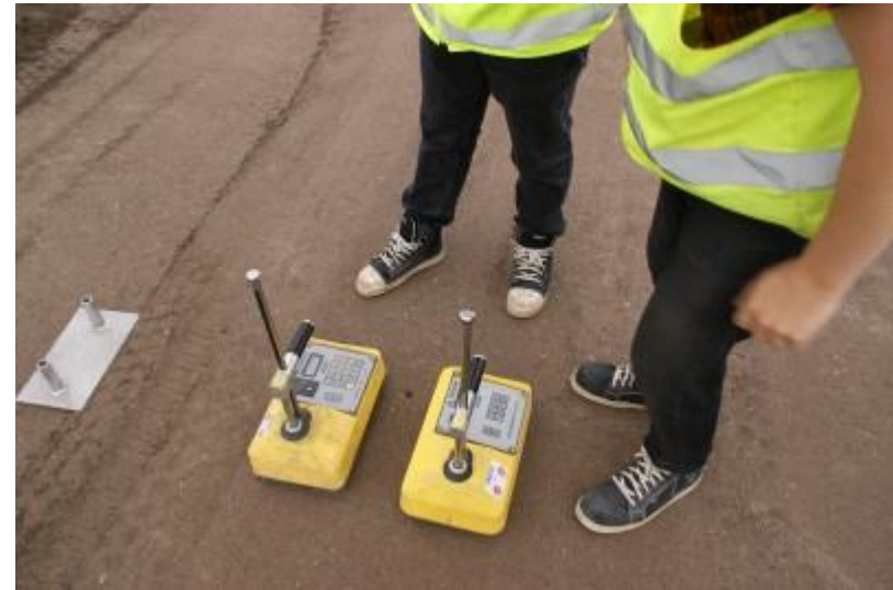
DSC05053 2. jyräyksen jälkeinen troxler-mittaukset
