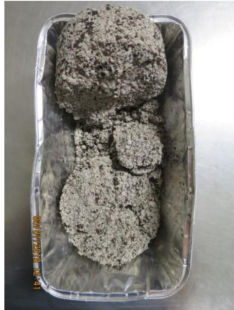
Koekappale V4 kuivana kokeen jälkeen. Koekappale oli niin löyhä, että se hajosi näytteen purkamisen yhteydessä
