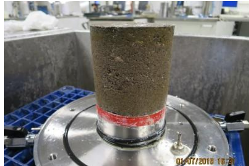
Koekappale V1a kokeen jälkeen
