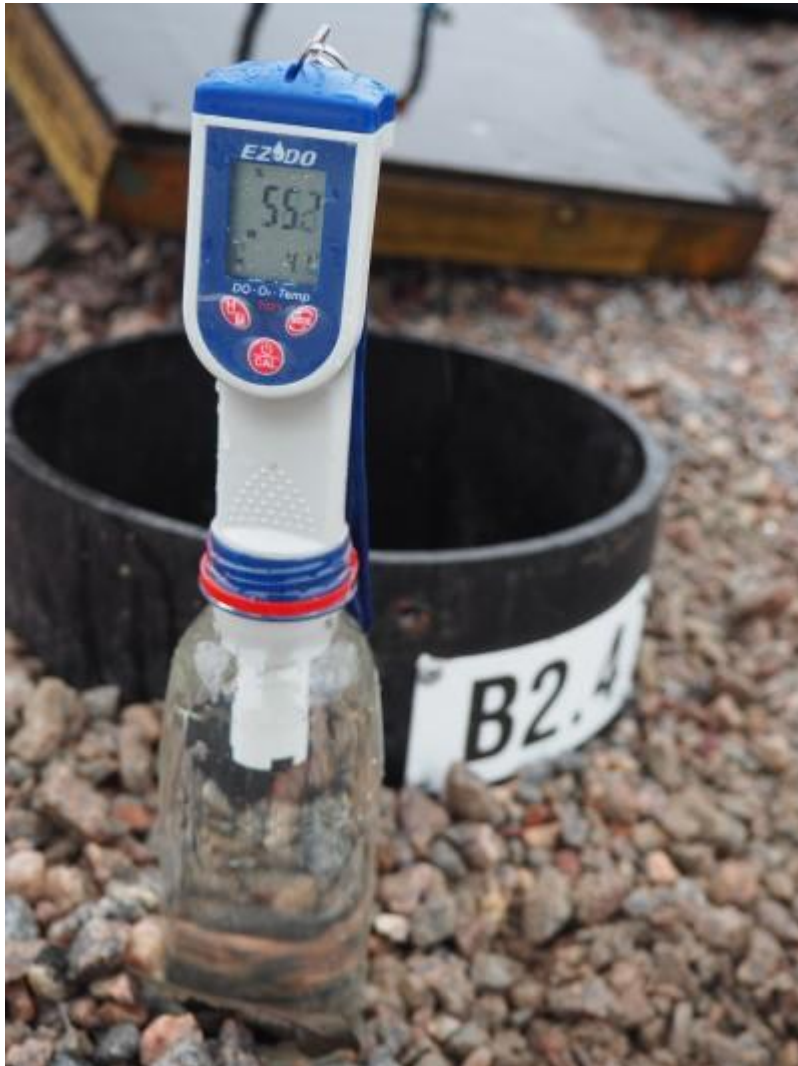
P4091249 Happipitoisuuden mittaaminen kenttämittarilla. Näyte otettiin sekoittamattomasta kaivovedestä
