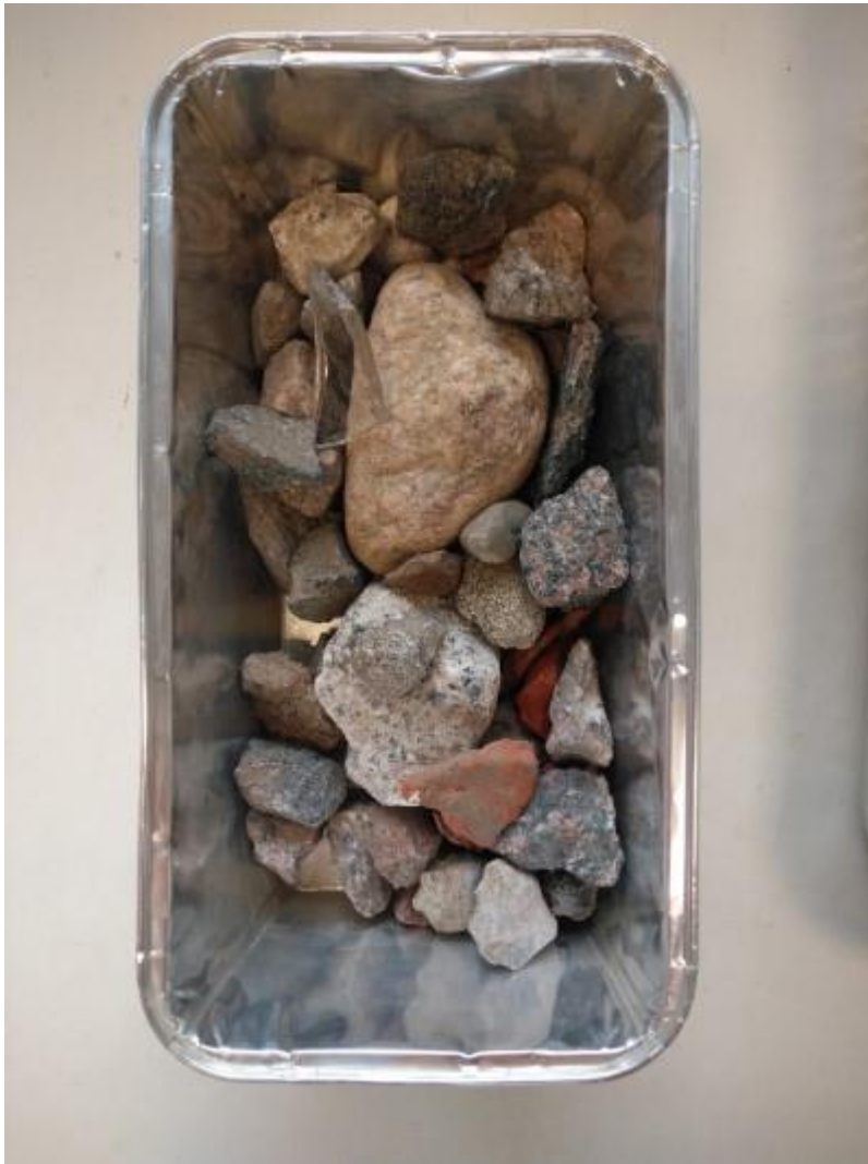
Kiintotiheys: koepintarakenteen A.2 pintakerroksen Hki-moreenin > 16 mm fraktio
