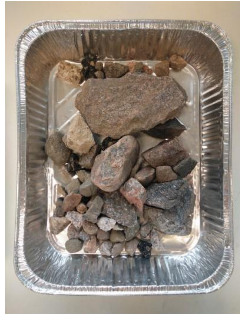
Kiintotiheys: koepintarakenteen C.0 Helsinki-moreenin > 16 mm fraktio
