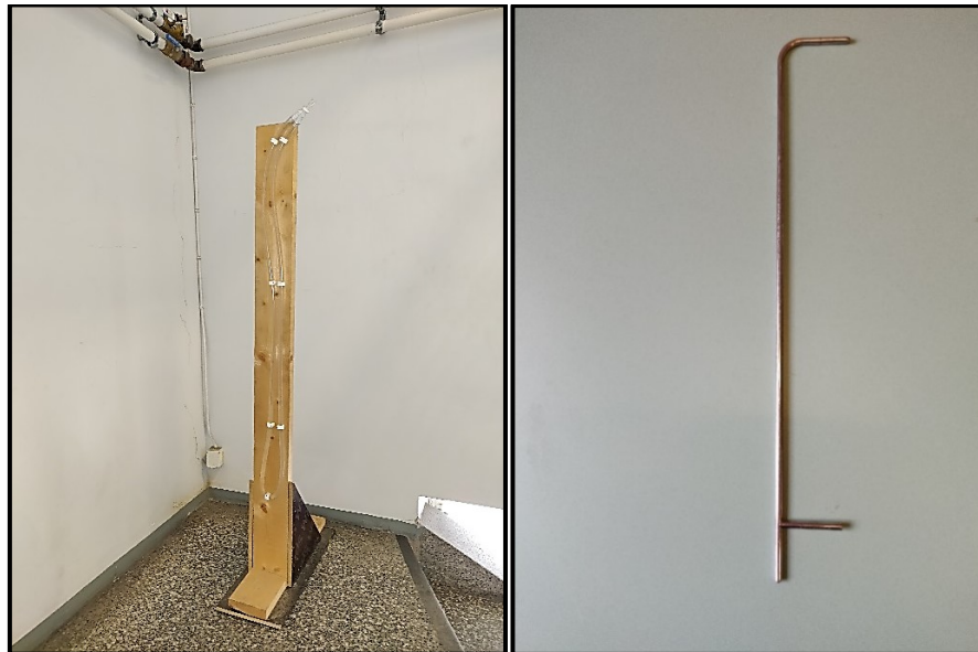
Kuva 18. Vasemmassa kuvassa esitetty U-putki manometri. Oikeassa kuvassa esillä mittauksissa käytetty Pitot-putki
