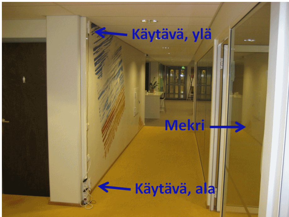
Kuva 4.15 Mekrin viereisen käytävän ylä- ja alaosaan asennettiin hiilidioksidi- ja lämpömittarit, kun haluttiin selvittää, miten CO 2 -pitoisuus ja lämpötila muuttuvat käytävässä Mekrissä pidettävän palaverin aikana.
