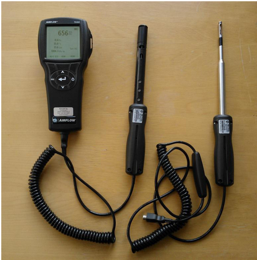
Kuva 3.4 Kalibroinnissa ja mittausten tukena käytetty käsimitari TSI Airflow TA460 ja sen kaksi mittauspäätä. Kuvassa keskellä hiilidioksidipitoisuuden, lämpötilan sekä suhteellisen kosteuden mittauspäätä 980 Probe ja oikealla ilmavirran nopeuden mittaamiseen 964 Probe.
