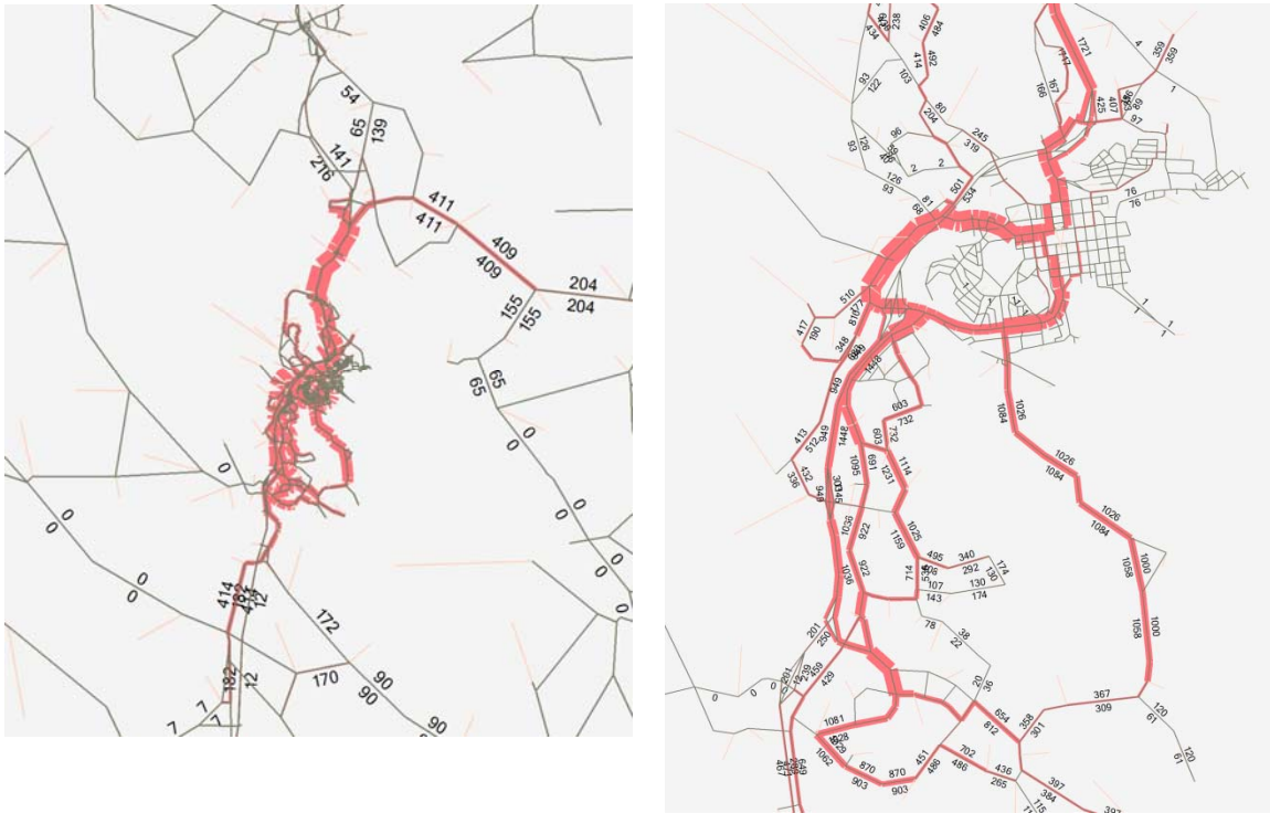
Kuva 4.20 Mallin mukainen joukkoliikenteen matkustajamäärä koko alueella ja Kuopion keskustaajamassa arki- vuorokauden aikana vuonna 2011.
