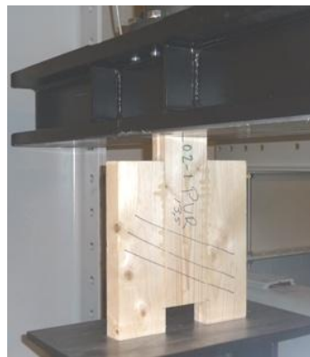
Kuva 4.11. Periaatekuva liimasauman leikkauskoestuksesta.
