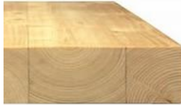
Kuva 2.2. HQL-sahatavarapalkki (Palsgaard Trae 2011).
