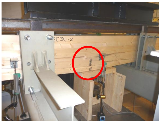
Kuva 4.21. Koekappale T15 C30-2 taivutettuna murtoon. Murto alkanut sormijatkoksesta, joka on 0,1 m palkin keskikohdasta.
