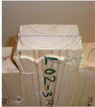
Kuva 4.14. Koekappaleen L02-3 tyssäntyminen eli puun puristusmurto.
