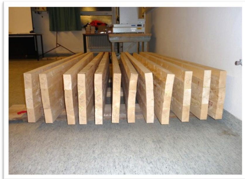
Kuva 4.2. Muodonmuutoskokeen M08-, M06-, M05- ja M04-ryhmien koekappaleiden säilytys. Kussakin ryhmässä on 3 koekappaletta.
