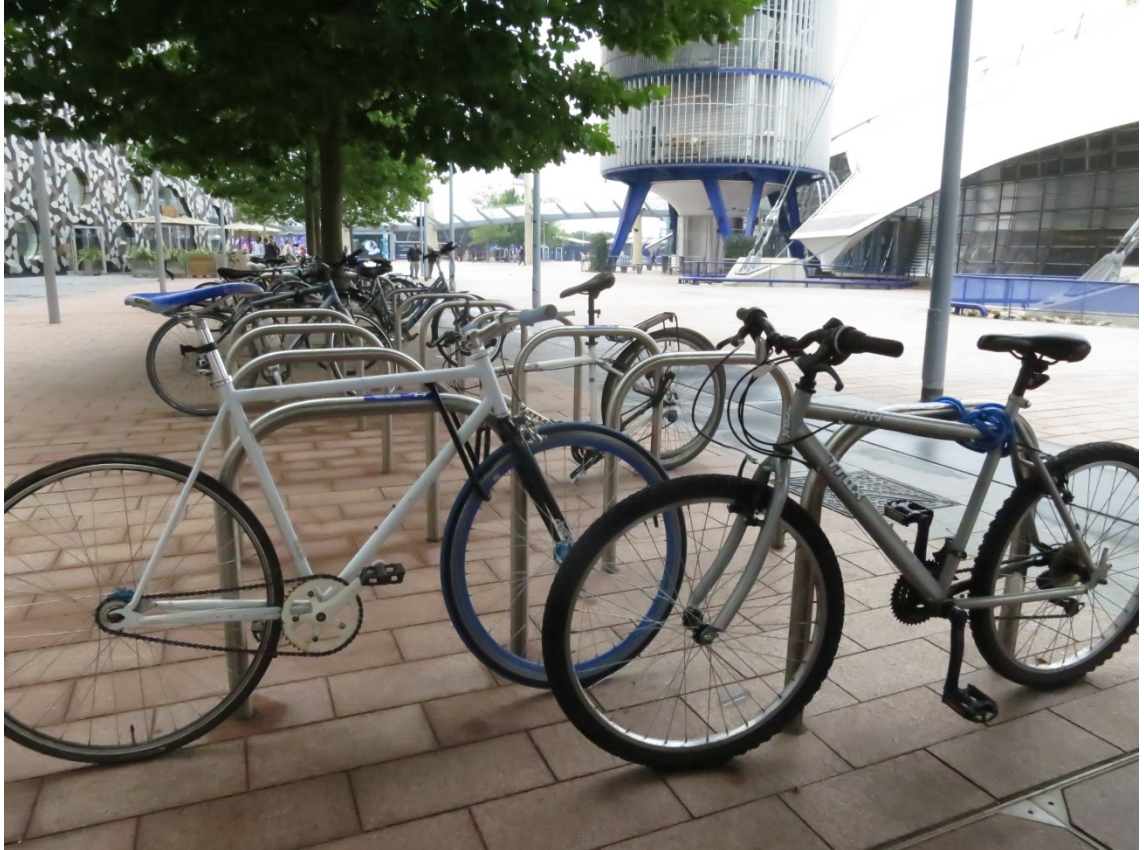
Kuva 25. Putkikaariteline (Sheffield stand) on suositeltava teline-malli, sillä siihen saa pyörän lukittua rungostaan kiinni. Kuva on Lontoosta. Kuva: Kalle Vaismaa 2013.
